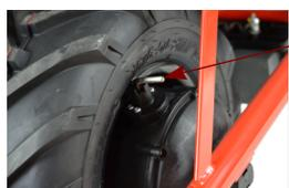
Durch das Ziehen der Antriebsklinke kann der Motor in den Freilauf geschaltet werden und die Karrette kann ohne Motorenwiderstand gestossen werden.
