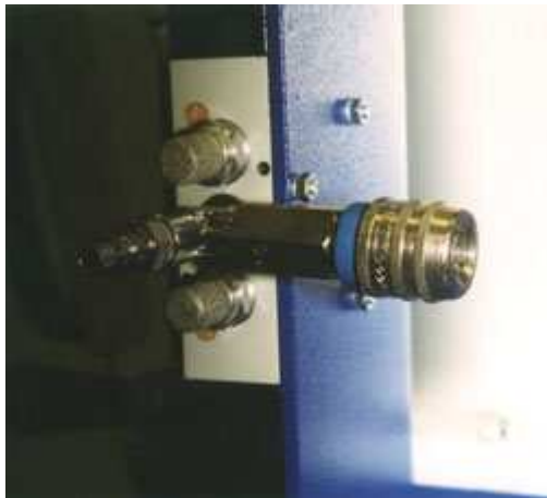
Druckluftanschluss (Schlagschrauber, Blaspistole etc.)
